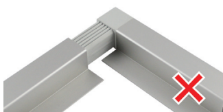
Gehrung Profilstege FALSCH: zwei mal 90° Steg
